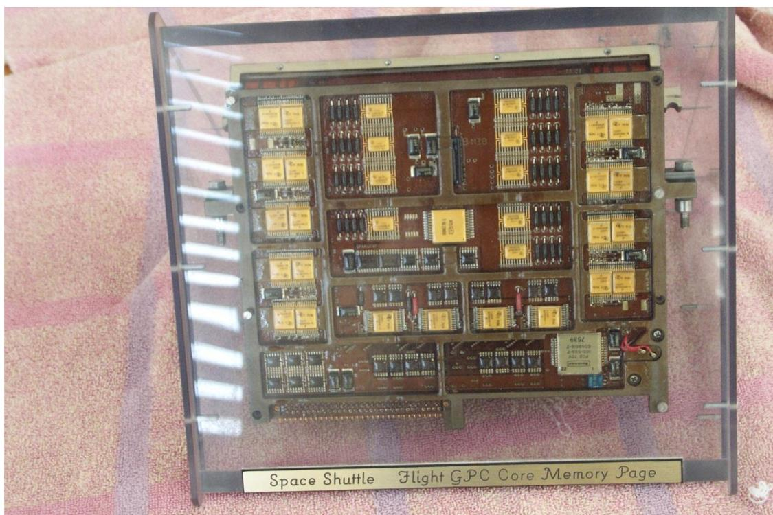
シャトルに搭載されたのは開発初期から多少仕様変更された AP-101B だったが、1990 年代に新しい AP-101S に載せかえられている。AP-101S はメモリをコアメモリから半導体メモリに変更し、メモリ空間を 1 メガバイトまで拡張した。速度は 1MIPS まで向上し、サイズと重量は半分になった。しかしシャトルに用意されている搭載空間は変わらないから、以前の 1 台のモジュールケースの中に 2 台の AP-101S が入るという構成になっている。
